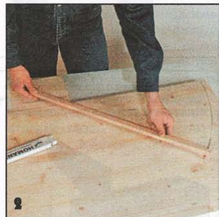
Контуры полок с большим радиусом закругления размечают с помощью самодельного циркуля. Радиусы закругления основания и полок составляют (снизу вверх): 142, 187, 244, 302 и 402 мм.
