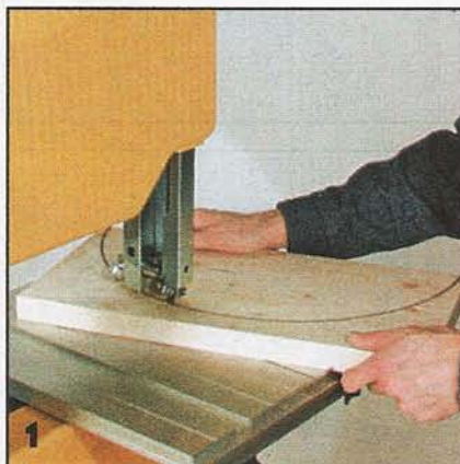
Сначала выпиливают любым доступным способом полки с меньшим радиусом закругления.
