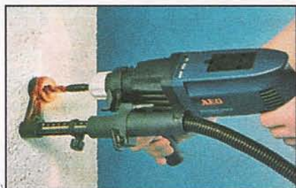
Отсасывание пыли непосредственно из области сверления.
